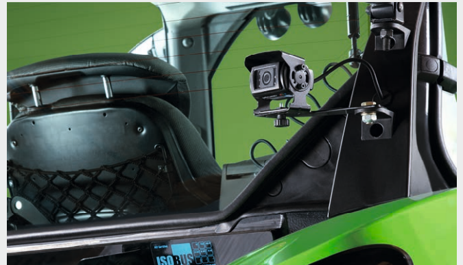
↑ Integrierte Kamera mit automatischen Vollbildmodus (z.B. Rückwärtsfahrt) schafft Übersicht und Sicherheit.
