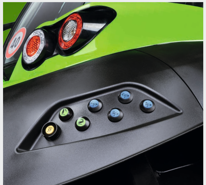
↑ Externe Steuerung der Hydraulik- und Zapfwellenfunktionen von beiden Seiten möglich.
