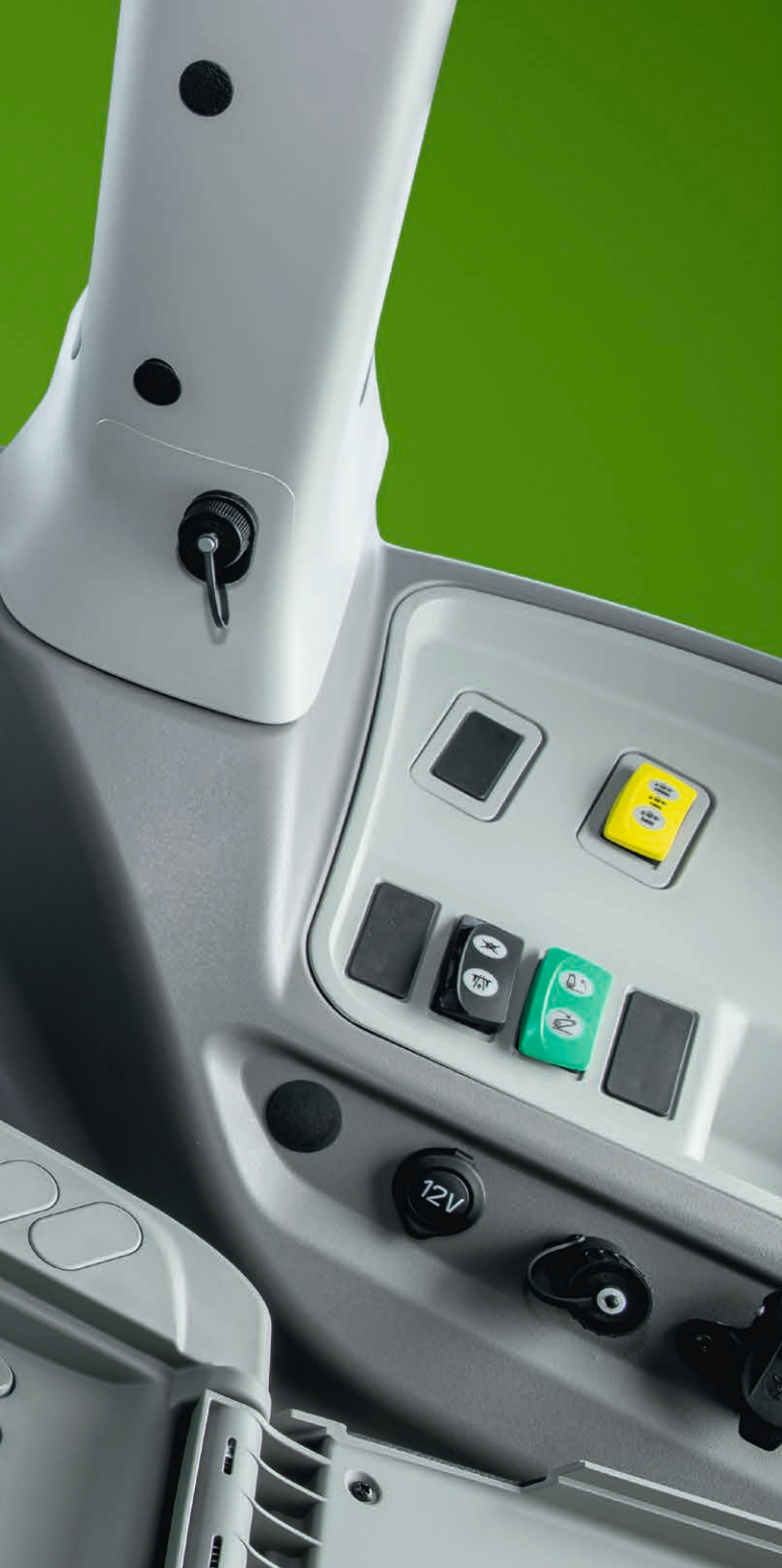
Über den Kreuzsteuerhebel mit Wippschalter lassen sich drei hydraulische Steuergeräte bedienen.
