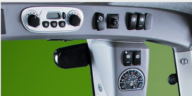
↑ Fahrlicht, Arbeitslicht und Kabinenlicht in einem Bedienpanel zusammengefasst. Arbeitsklima vorwählen, die Automatik steuert die Luftströme präzise.
