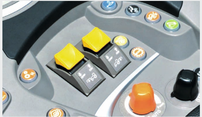
Die Zapfwelleneinstellung und -aktivierung ist griffgünstig in die Armlehne integriert ...
