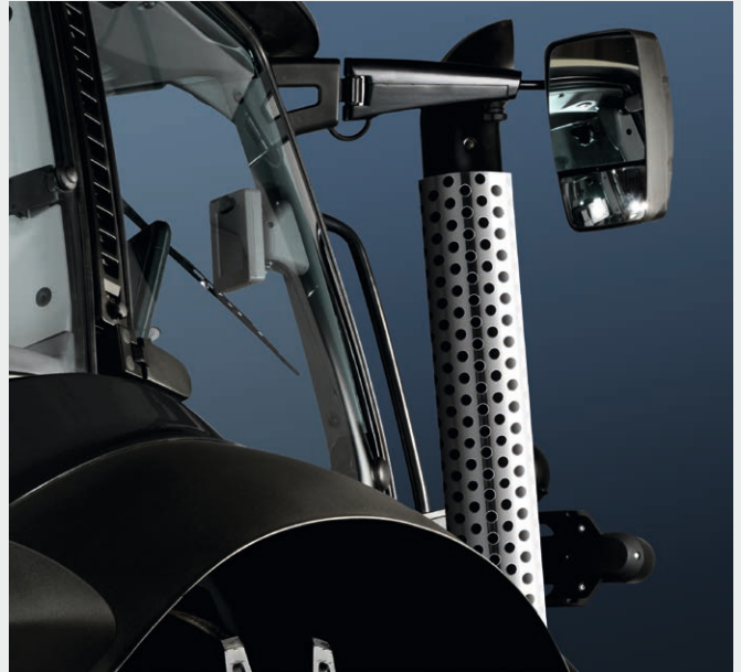
↑ Auspuff mit Edelstahlverkleidung.
