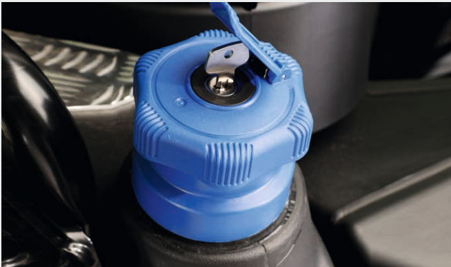
↑ Abschließbare Tankdeckel für Kraftstoff- und AdBlue-Tank.
