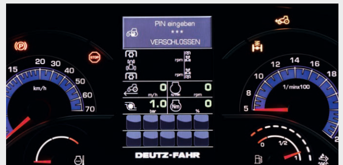
↑ Das neue InfoCenter hält den Fahrer auf dem Laufenden: analoge und digitale Informationen über den Betriebszustand. Sicherheit dank der Code-Sicherung vom Schlepper. Sperren und entsperrten mit PIN.
