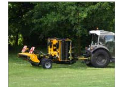
Geringe Transportmaße und eine Fahrwerkskonstruktion mit breiter Bereifung sorgen für eine ruhige und bodenschonende Fahrt.
