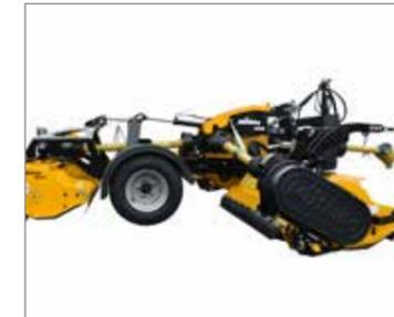
Effizienter Antriebsstrang, kompakt ausgelegt für hohe Antriebsleistungen. Das Mittelgetriebe ist mit integrierten Abschaltkupplungen rechts und links ausgestattet (optional).
