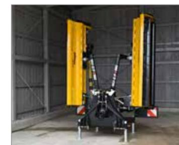
Dank durchdachter Bauweise lässt sich das MU-E/F Vario Mulchgerät platzsparend zusammengeklappt abstellen.
