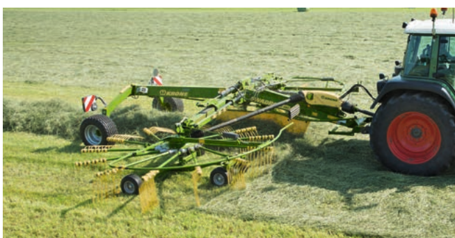
Zweikreisel-Mittelschwader Swadro TC und TC Plus Variable Arbeitsbreiten von 5,70 m bis 10,00 m
