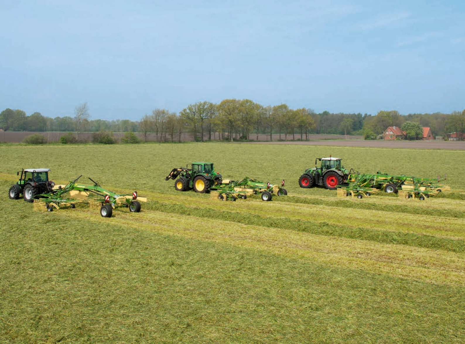
Vierkreisel-Mittelschwader Swadro TC 1250 Variable Arbeitsbreiten von 9,80 m bis 12,50 m
