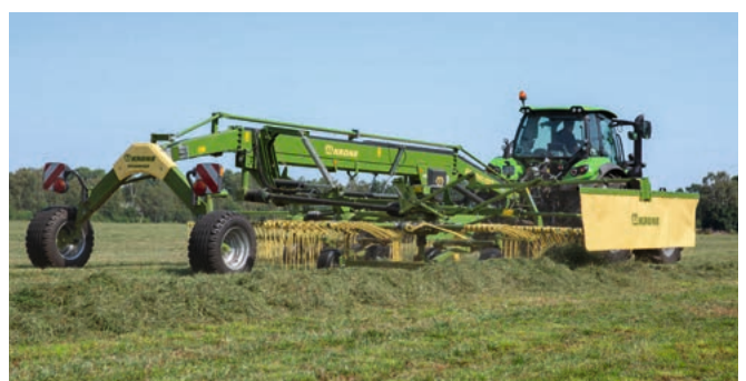
Dreikreisel-Seitenschwader Swadro TS 970 Arbeitsbreite 9,70 m
