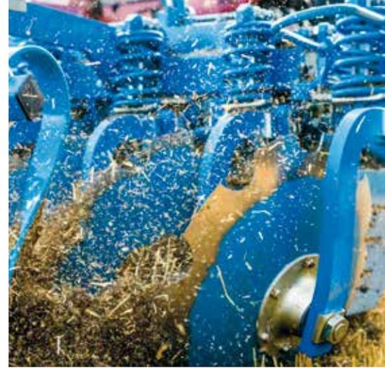
Bisher sorgten Kurzscheibeneggen für eine intensive und homogene Vermischung von Boden und organischer Masse bis zu einer Arbeitstiefe von etwa 14 cm.
