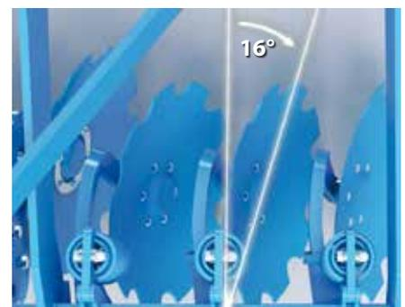
Die Hohl­scheiben des Rubin 12 sind einzeln an einem hochvergüteten Halm angebracht. Dessen spezielle Form sorgt für maximalen Freiraum zwischen den Scheiben.
