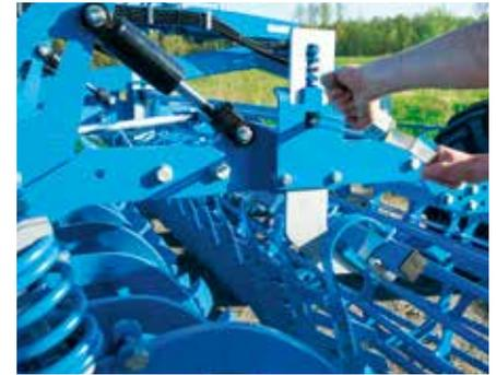
Der Nivellierstriegel hinter der zweiten Scheibenreihe hinterlässt eine ebene Oberfläche:
