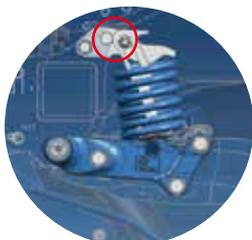
Nach dem Auslösen federt das Element nach unten durch. Der Anschlag kann sich nach unten bewegen, so dass sich die Rückschlagenergie der Feder im Boden abbaut.
