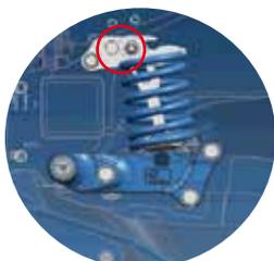
Bei Hindernissen weichen die Scheiben einzeln nach oben aus und werden schnell wieder in die Arbeitsposition zurückgeführt. Dabei drückt die Spiralfeder in der Ausgangslage den Anschlag nach oben.
