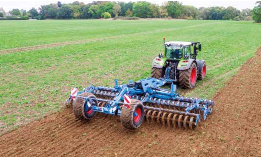
Das Konzept der Kurzscheibenegge Heliodor von LEMKEN beruht auf zwei Reihen einzeln an Blattfedern aufgehängten Scheiben. Damit ist eine gute Boden Anpassung garantiert und auch steinige Felder können störungsfrei bearbeitet werden. Die Scheiben sorgen bei der Stoppelbearbeitung für eine intensive Vermischung von Boden und Bewuchs.
