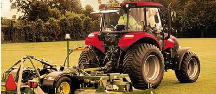
Reifen mit bodenschonendem Profil sind für die Pflege von Sport- und Parkanlagen geeignet.
