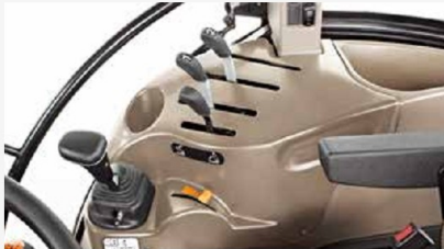
Bei den Traktoren der Baureihe Farmall A sind im Heck bis zu drei mechanische Steuergeräte verfügbar.
