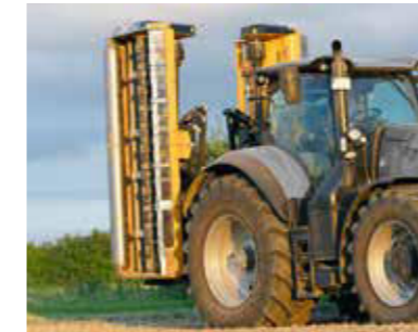
Kurze Bauweise für einen Schwerpunkt nah am Traktor (Quickhitch-geeignet).
