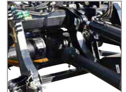
Das Getriebe: Ausgelegt für Antriebsleistungen von bis zu 400 PS.
