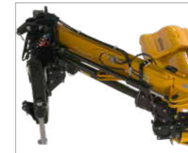
Aufgeräumt: die Schlauchverlegung.
