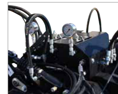
Aufgeräumt: Die Bordhydraulik mit der hydro-pneumatischen Auflagedruckentlastung MU-SOFA®.
