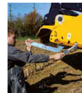
Einfaches Verstellen der Schwenk-Stützwalze, auch ohne zusätzliche Helfer.
