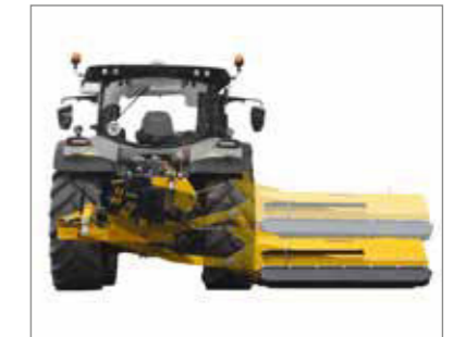
Die Höhe des Mulchgerätes lässt sich hydraulisch einstellen. Damit können auch Plateaus neben dem Traktor gemulcht werden.
