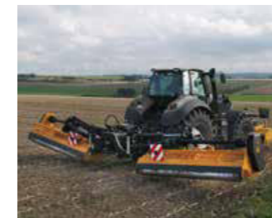
Schnelles Zusammenklappen dank der Freiläufe in den Endantrieben.
