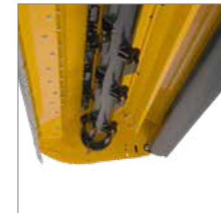
Für eine verstopfungsfreie Ablage sorgt die integrierte Gutleitklappe.
