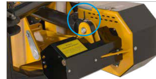
Gut zu erreichende Transportsicherung.
