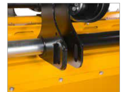
Langlöcher in Kat.3N an den Ober- und Unterenkerbaupunkten ermöglichen zusammen mit der Schwenk-Stützwalze eine sehr gute Boden Anpassung.
