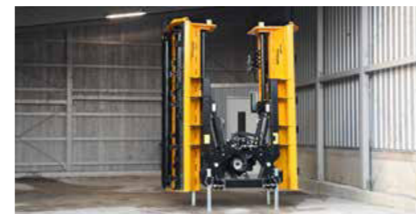
Dank durchdachter Bauweise lässt sich das MU-M/F Vario Mulchgerät platzsparend zusammengeklappt abstellen.
