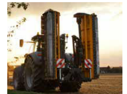
Clever geklappt: Minimale Gerätehöhe durch Parallelogrammaufhängung der beiden Mulchgehäuse.
