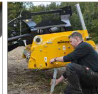
Einfaches Verstellen der Schwenk-Stützwalze, auch ohne zusätzliche Helfer.
