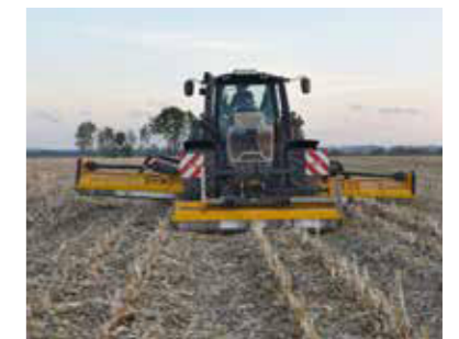
Die Mulchgehäuse lassen sich auch einzeln ausheben (optional).
