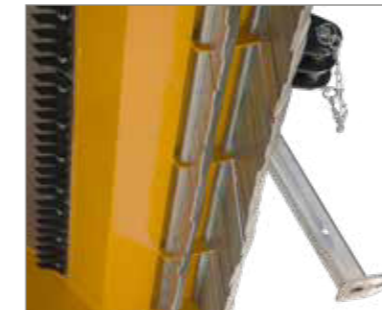
Zweifache Sicherheit mit doppeltem Pendelklappenvorhang aus Federstahl.
