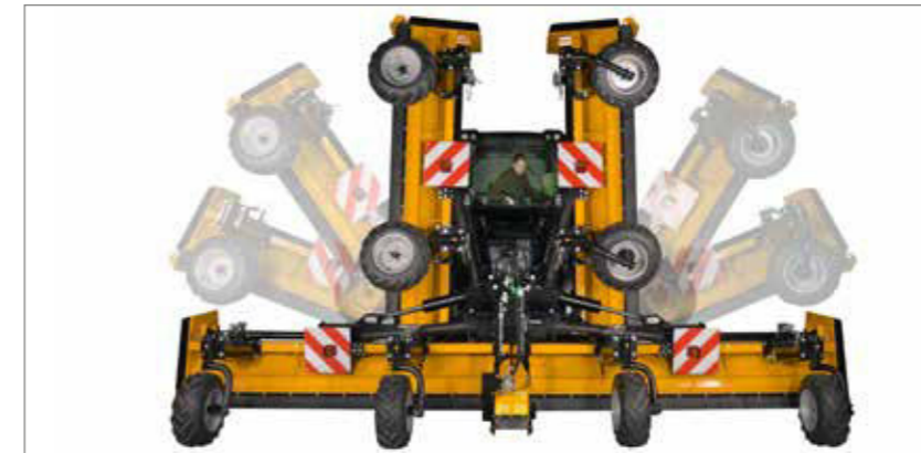
Schneller Wechsel von Transport- in Arbeitsstellung. Übersichtliche Transportstellung mit 2,85 m Transportbreite und 3,60 m Transporthöhe.
