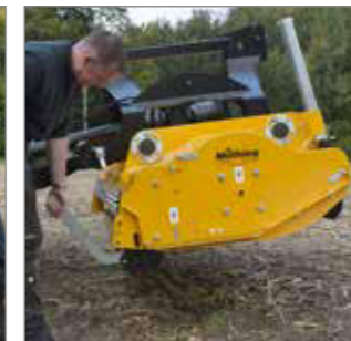
Einfaches Verstellen der Schwenk-Stützwalze, auch ohne zusätzliche Helfer.
