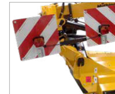
Warntafeln mit Beleuchtungseinrichtung und Beleuchtungsträger robust befestigt, ohne bewegliche Bauteile
