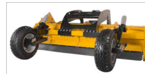
Bodenschonende Stützräder zur Höheneinstellung am Farmer für den Heckanbau. 180° schwenkbar für hohe Wendigkeit am Vorgewende. Ganzflächige Tiefenführung mit der großen Stützwalze am Farmer für den Frontanbau.
