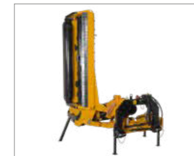
Dank durchdachter Bauweise lässt sich das MU-LV/S Mulchgerät platzsparend zusammengeklappt abstellen.
