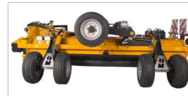
Doppelt bereiftes Ackerfahrwerk zur bodenschonenden Gewichtsverteilung und exakten Tiefenführung.
