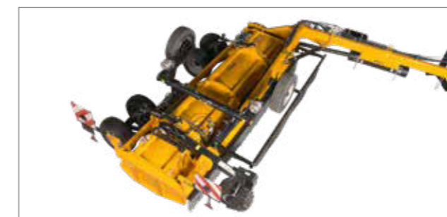
Straßentransport: Schnell vom Fahrersitz aus umgestellt und manuell gesichert.
