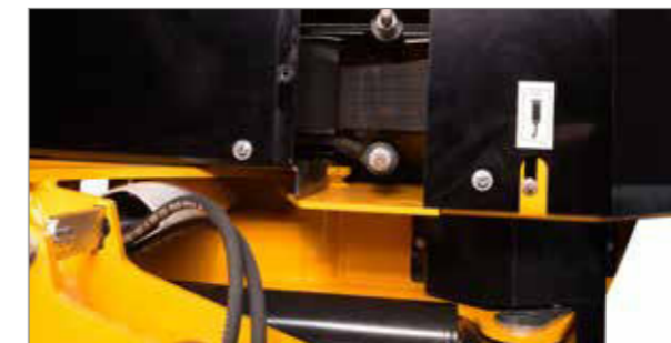
Störungsfreies und wartungsarmes Arbeiten durch die effektiv ausgeführte automatische Riemenspannung. Die gut zugängliche Wartungsklappe erlaubt einen schnellen Blick auf den Powerriemen.
